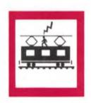
Влезать на вагоны. Напряжение в проводах достигает 27500 вольт. (дома в электрической розетке-220 вольт). Смертельный ожог может произойти на расстоянии 1-2 метров от контактного провода!
